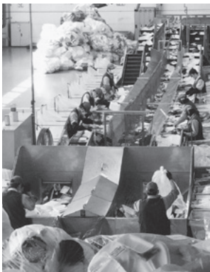
使用済みトレーの選別作業状況
